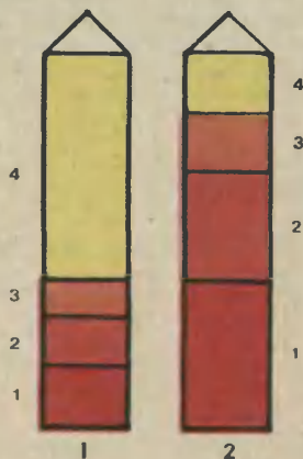
Распределение массы четырехступенчатой ракеты между ее ступенями: 1 — неправильное распределение; 2 — правильное распределение.
